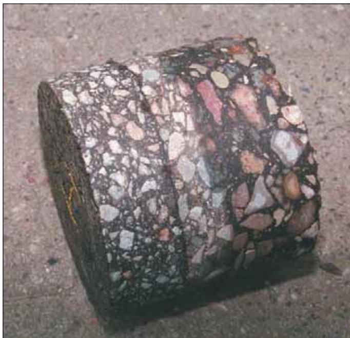
Optimal vedhæftning mellem to lag asfalt med HaTelit®
